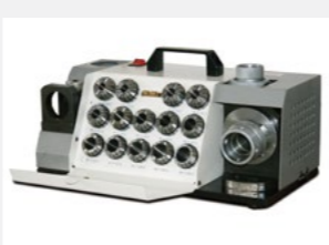
GH 15T • 6 цанг ER 20, от Ø 3 до Ø 8 мм • 22 цанги ER 40, от Ø 8 до Ø 30 мм
